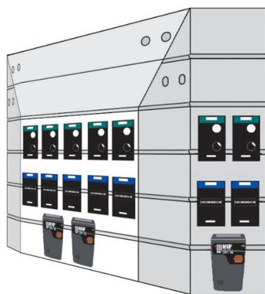
**Рис.1.** Расположение термолуминесцентных и электронных прямопоказывающих дозиметров на фантоме.
