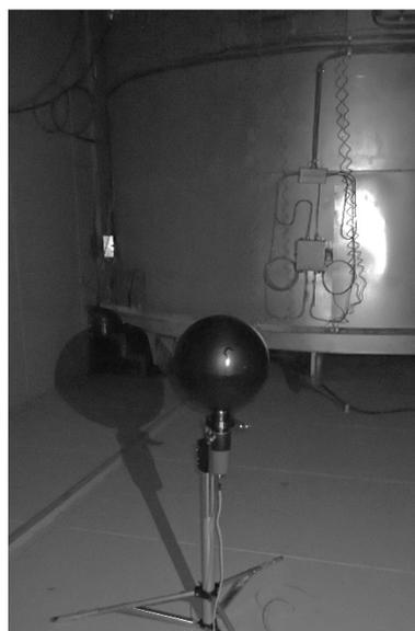
**Рис.3.** Размещение блока детектирования БДКН-06: в хранилище свежих тепловыделяющих сборок (фото слева) и за биологической защитой реактора в помещении барабана свежих сборок (фото справа).
