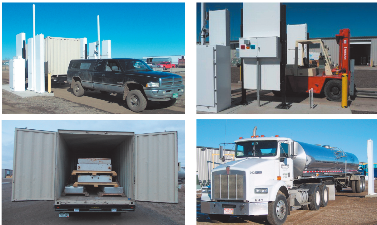
Рис.5. Различные типы транспортных средств, с которыми проводились тесты без источников излучения для определения частоты ложных срабатываний.
