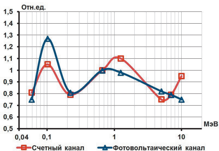
Рис. 3. Энергетическая зависимость чувствительности устройства детектирования УДКГ-37.
