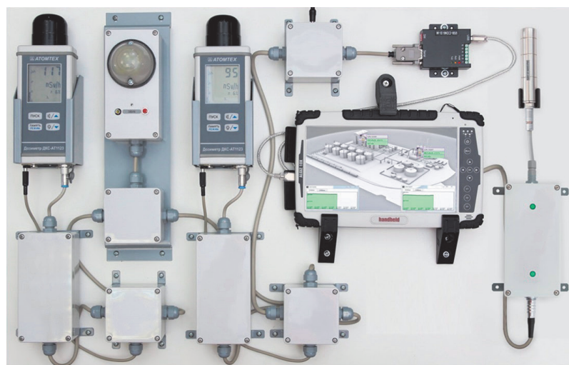
Рис.4. Устройство детектирования УДКГ-37 в составе системы радиационного контроля импульсного излучения ускорителей.
