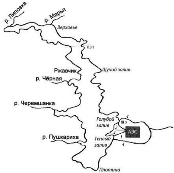
**Рис.1.** Схема водоема-охладителя Белоярской АЭС. 1 – сбросной канал; 2 – водозаборный канал; 3 – ПЛК; 4 – обводной канал; 5 – БФС [1].
