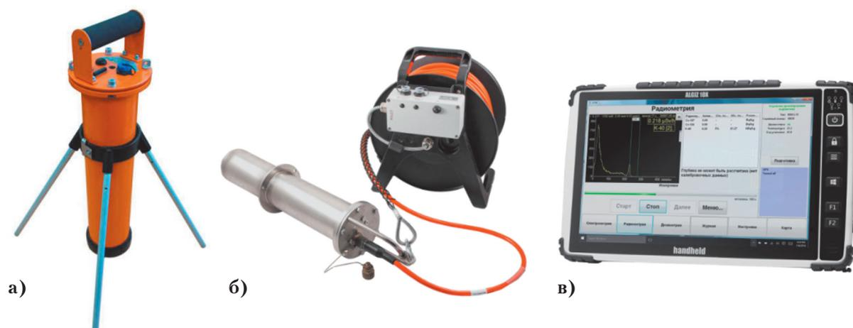
**Рис.2.** Средства измерения для проведения исследования *in situ*: а – МКС-АТ6101ДР, б – МКС-АТ6104ДМ, в – планшетный ПК.
