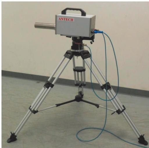
Рис.4. Прибор RadSearch Model G3050 на штативе.
