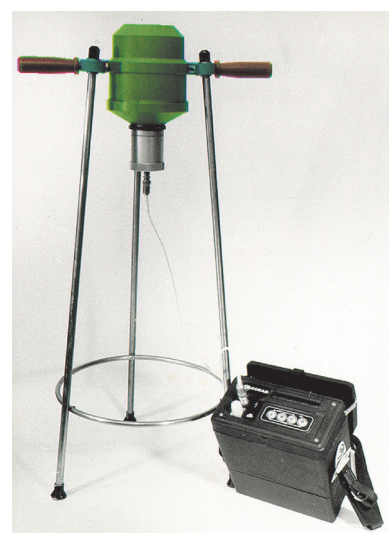
Рис. 7. Пример применения метода КОРАД при измерениях загрязнений ^{137}\text{Cs} после Чернобыльской аварии в городе Новозыбков Брянской области, Россия (1993 г.). Слева – фотография первого варианта коллимированного детектора на треноге с портативным МКА [14]. Справа – фрагменты карт загрязнения. 1 – поверхностная активность (мкКи/м 2 ), 2 – заглубление (дсп), 3 – толщина чистого слоя (дсп), 4 – мощность дозы (мкР/ч).
