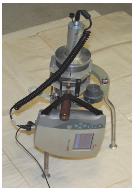
Рис.8. Система на основе коллимированного детектора \text{LaBr}_3 и многоканального анализатора Inspector-1000.
