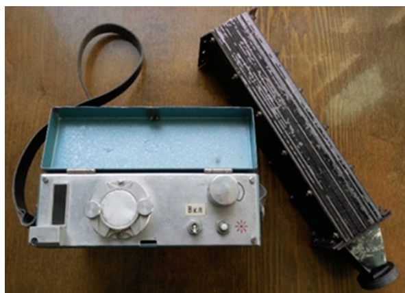
Рис.3. Устройство отбора проб ВПИМ-10, -12 и диффузионная батарея пластинчатого типа.
