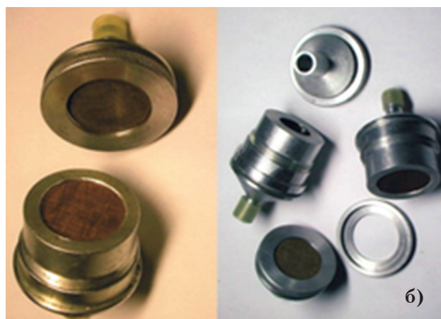
Рис.4. Комбинированный блок диффузионных и аэрозольных фильтров к радиометрам РГА-01Т и РГА-02Т. а) схема комбинированного блока б) внешний вид составляющих комбинированного блока. 1 – корпус; 2 – система сеточных фильтров; 3 – аэрозольный фильтр; 4 – прокладка; 5 – тонкая прокладка.
