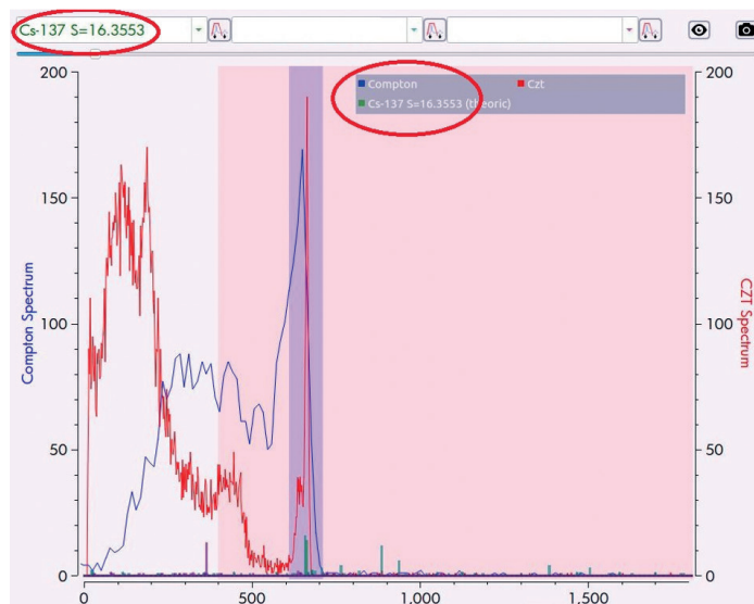
Рис.3. Спектрометрический анализ и определение радионуклида на примере ЗРИ с нуклидом Cs-137 (снимок рабочего окна из ПО установки).
