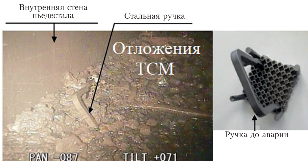
Рис.5. Ручка контейнера топливных стержней среди отложений ТСМ во 2-м блоке.
