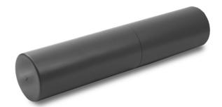
**Puc.1.** Внешний вид спектрометрического блока детектирования на основе сцинтиллятора  $LaBr_3$  (Ce).
