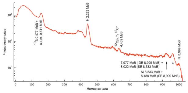
**Puc.6.** Спектр гамма-излучения, полученный с помощью блока детектирования с кристаллом NaI(Tl) при использовании мишени из никеля.
