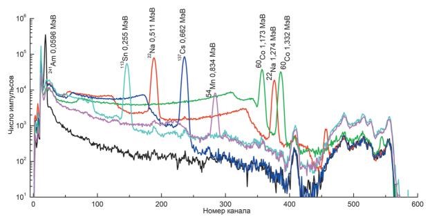
**Рис.7.** Нормированные по времени аппаратурные спектры от различных источников типа ОСГИ, полученные на спектрометре с  $LaBr_3(Ce)$ -детектором.
