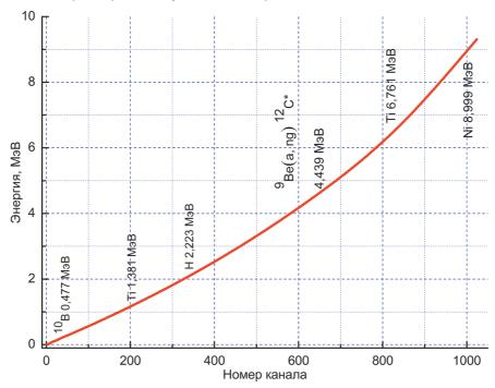
**Рис. 8.** Характеристика «канал-энергия», построенная для спектрометра LaBr<sub>3</sub> (Ce).
