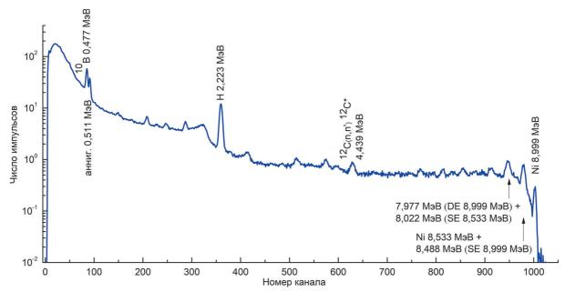
**Puc.4.** Спектр гамма-излучения, полученный с помощью блока детектирования с кристаллом  $LaBr_3(Ce)$  при использовании мишени из никеля.
