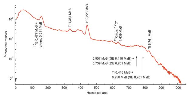
**Puc.5.** Спектр гамма-излучения, полученный с помощью блока детектирования с кристаллом NaI(Tl) при использовании мишени из титана.
