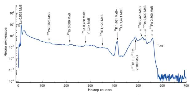
**Рис.2.** Фоновый спектр, набранный на спектрометре с кристаллом  $LaBr_3$  (Ce), используемым в работе.
