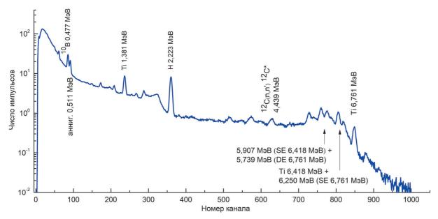
**Рис.3.** Спектр гамма-излучения, полученный с помощью блока детектирования с кристаллом  $LaBr_3(Ce)$  при использовании мишени из титана.
