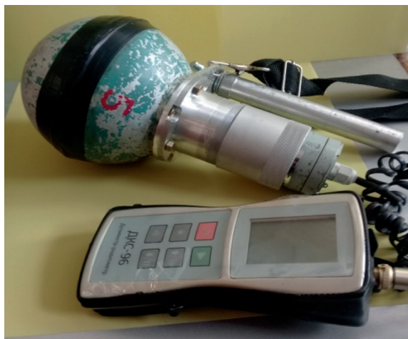
Рис.3. Внешний вид ДКС-96Н с блоком детектирования БДМН-96 5 дюймов и стандартный блок детектирования БДМН-96 [6].
